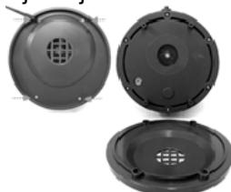
3. Otpustite 6 vijaka i odvojite poklopac kako biste izložili tiskanu pločicu, sklop motora i komplet s baterijom.
