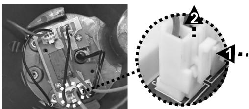
5. Otpustite 3 vijka kako biste otklonili poklopac odjeljka baterije, a zatim otklonite komplet s baterijom. NAPOMENA: Konektor odmah zaštitite izolacijskom ljepljivom trakom kako biste izbjegli kratki spoj uzrokovan kontaktom s oba terminala.
