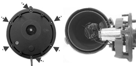
4. Za odspajanje ožičenja baterije pritisnite držać na konektoru i zatim ga izvucite.
